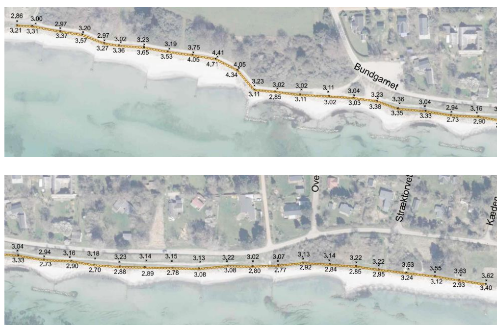
Figur 2-19 Opmåling af dige. Her kote til top af stenkastning og terræn bagved på digekronen. Øverst vest og nederst øst del af diget.
